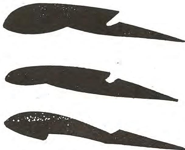
On voit l'évolution de ces profils avec un renflement à l'avant et un décrochement à la partie dorsale. Ces profils datent de 1921. Budig est un chercheur très connu pour ses recherches sur les canards et ses avions légers à faible puissance.
