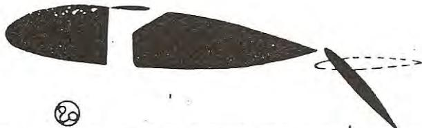
Toute une collection d'essais a été faite par le N.A.C.A., sur le profil Clark Y, avec des bacs, des fentes, des volets, etc. Un volume ne suffirait pas pour les résultats même condensés, mais très intéressants de ces recherches.
